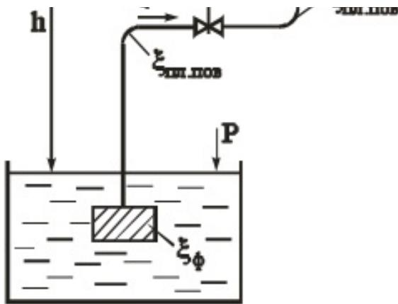
41. Наполнение бассейна из магистрали с заданным давлением  $P_m=2,5 \text{ кгс/см}^2$  производится по горизонтальной трубе, снабженной вентилем ( $\xi_v=4$ ) и отводом ( $\xi_p=0,3$ ). Определить диаметр трубопровода, который обеспечит наполнение бассейна объемом  $W=36 \text{ м}^3$  за время  $t=30 \text{ мин}$ . Потерями по длине пренебречь.  $\gamma=9810 \text{ Н/м}^3$ .
