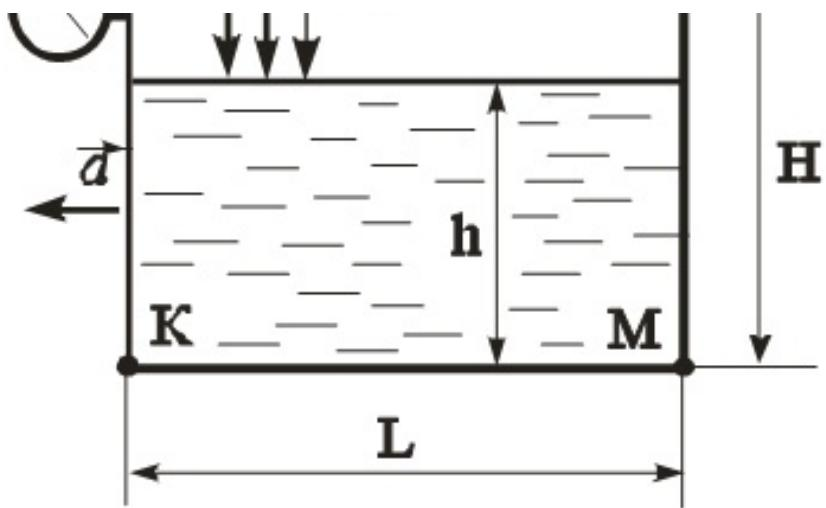
50. Вода по трубе Т попадает в бак А в количестве  $Q=10 \text{ л/с}$ . Далее вода из бака А поступает в бак Б через внешний цилиндрический насадок диаметром  $d=50 \text{ мм}$  ( $\mu_{\text{ц}}=0,82$ ), а затем через трубу того же диаметра  $d$  и длиной  $l=2 \text{ м}$  вытекает в атмосферу. Принять коэффициент гидравлического трения  $\lambda=0,03$ . Определить перепад  $h$  уровней воды в резервуарах, а также уровень  $H$  в резервуаре Б.
