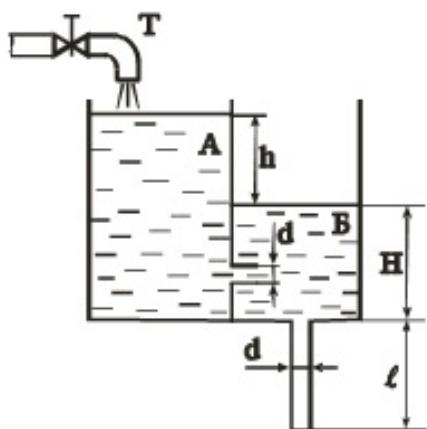
51. Определить расход бензина через жиклер Ж карбюратора диаметром  $d=1,2 \text{ мм}$ , если коэффициент расхода жиклера  $\mu=0,8$ . Сопротивлением бензотрубки пренебречь. Давление в поплавковой камере атмосферное. Разрежение (вакуум) в горловине диффузора  $P_{\text{вак}}=18 \text{ кПа}$ . Плотность бензина  $\rho_{\text{б}}=750 \text{ кг/м}^3$ .
