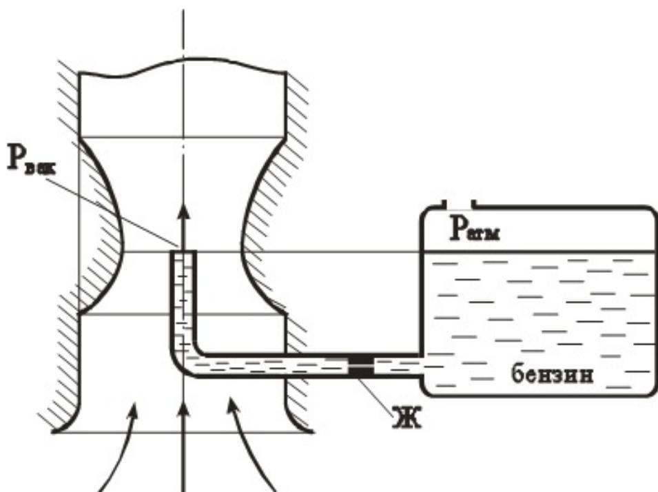
15. Определить максимальную величину высоты всасывания  $h_{bc}$ , если подача насоса  $Q=1$  л/сек, длина всасывающего трубопровода  $l=4$  м; диаметр  $d=25$  мм, коэффициент сопротивления входного фильтра  $\xi_\phi=5$ ; коэффициент плавного поворота  $\xi_{\text{п.п}}=0,4$ ; коэффициент  $\lambda=0,03$ . Максимально допустимый вакуум перед входом в насос  $P_{\text{вак}}=0,08$  МПа.  $\gamma=9810$  Н/м<sup>3</sup>.
