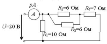
4. Определить режимы работы источников питания и составить баланс мощностей
