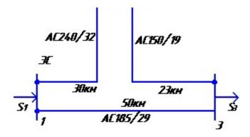
57. Кольцевая сеть напряжением 110 кВ, показанная на рисунке, связывает электростанцию 1 с понижающими подстанциями 2, 3, имеющими расчетные нагрузки S2=40+j30 MBA и S3=50+j28 MBA. Марки проводов, длины линий указаны на рисунке. Сопротивления их равны Z12=3,6+j12,5 Ом; Z23=10+j15 Ом; Z13=8+j15 Ом. Напряжение на шинах электростанции равно 118 кВ. Определить напряжения в узлах 2, 3, а также наибольшую потерю напряжения для сети, показанной на рисунке
