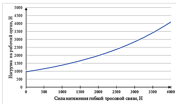
Рисунок 2 – Зависимость нагрузки на рабочий орган прикатывающего агрегата (каток) от натяжения гибкой тросовой части
