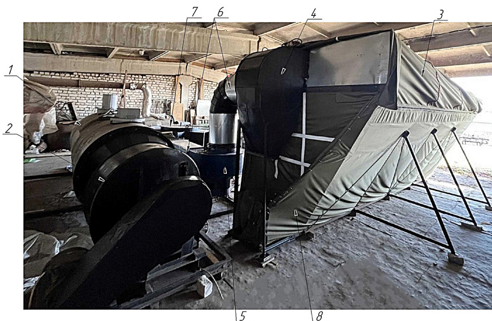
Рисунок 5 – Производственный образец аэродинамического устройства для сушки сыпучих материалов: 1 – теплогенератор; 2 – вентилятор для подачи агента сушки; 3 – оболочка сдвижного зонта; 4 – пылеуловитель; 5 – вентилятор аспиратор; 6 – воздухопроводы; 7 – клапан-смеситель с блоком автоматического управления поворотной заслонкой; 8 – боковой воздухоподводящий короб
