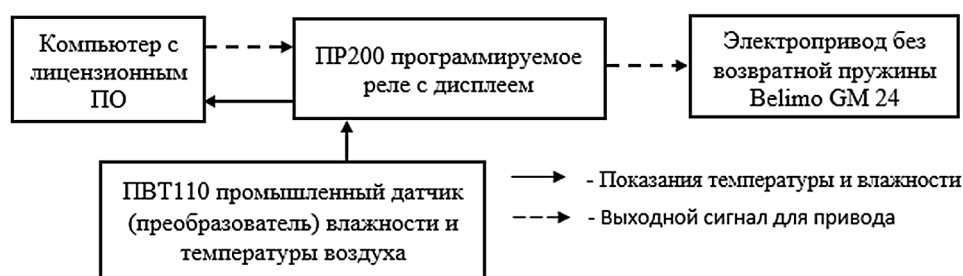
Рисунок 4 – Схема работы блока автоматического управления заслонкой клапана-смесителя системы рециркуляции отработавшего агента сушки аэродинамического устройства для сушки сыпучих материалов
