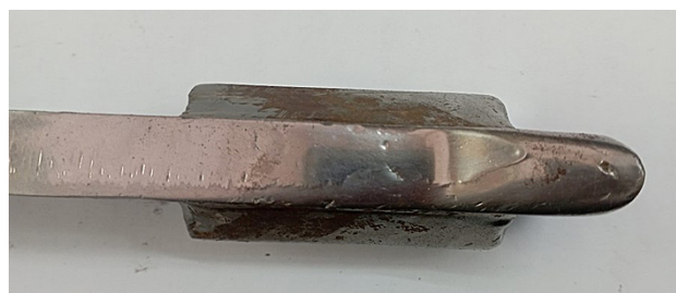
Рисунок 3 – Фигура и характер износа сошника, изготовленного из стали 65Г, с закалкой фронтальной поверхности: а – вид сбоку; б – вид на фронтальную поверхность
