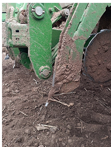
Рисунок 2 – Сгуживание растительного материала и почвы на сошник сеялки при его износе
