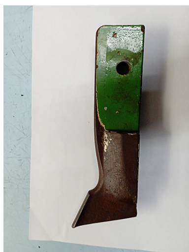
Рисунок 1 – Характер износа сошника-оригинала сеялки Primera DMC 9000
