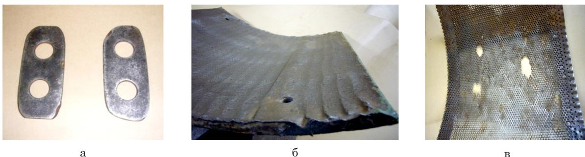
Рисунок 1 – Изношенные рабочие органы молотковой дробилки зерна:
