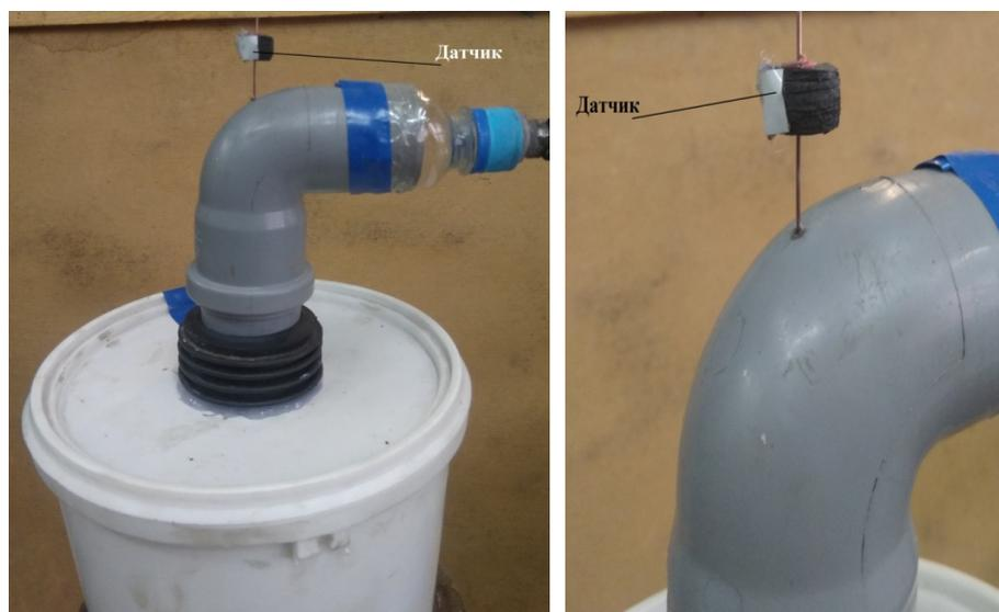
Рисунок 2 – Общий вид пылеуловителя с датчиком оборотов
