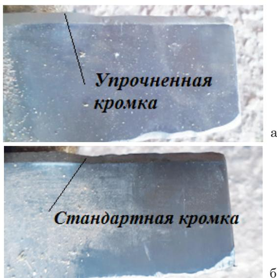
Рисунок 3 – Состояние режущих кромок после 800 га наработки
