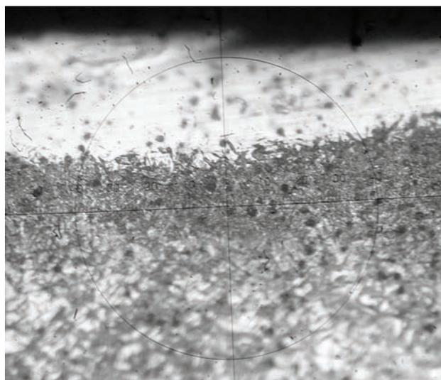
Рисунок 4 – Структура пор в зоне лазерной высокоскоростной перекристаллизации
