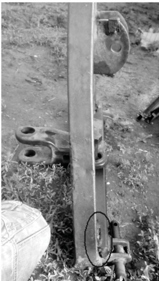
Рисунок 2 – Возникновение трещины в стыке рамки с опорой автоматической сцепки СА
