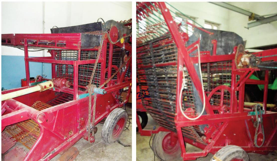
Рисунок 3 – Копатель-сборщик до установки ограждений
