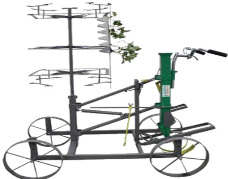
Рисунок 1 – Ручная рассадопосадочная машина PPM-1
