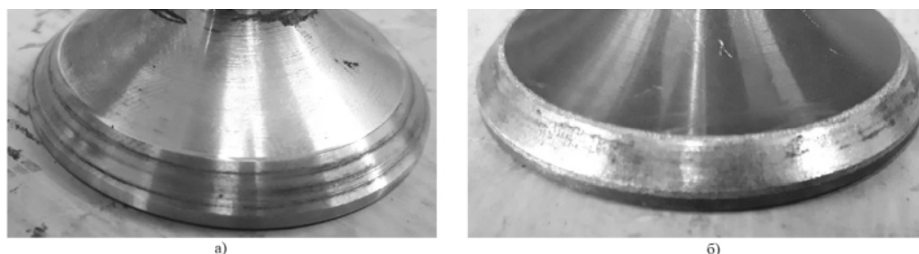
Рисунок 3 – Клапаны после испытаний: а) стандартный клапан; б) модифицированный клапан
