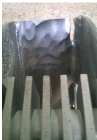
Рисунок 2 – Разрушение рабочего барабана
