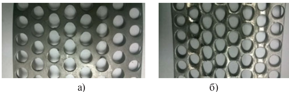
Рисунок 1 – Характер износа сепарирующих решет дробилки закрытого типа:
