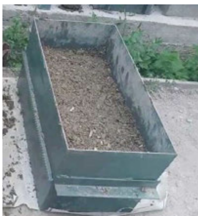
Рисунок 2 – Металлическая форма для производства лабораторного образца кострблока
