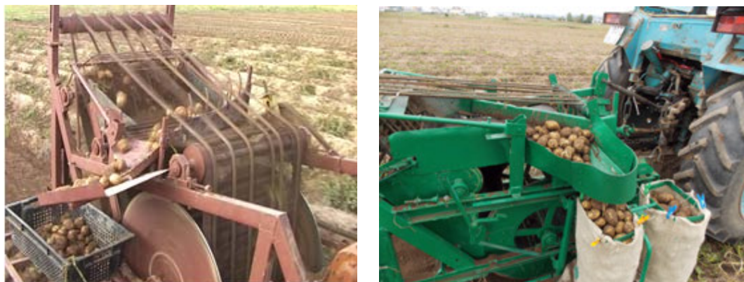
Рисунок 2 – Производственные испытания малогабаритного картофелеуборочного комбайна
