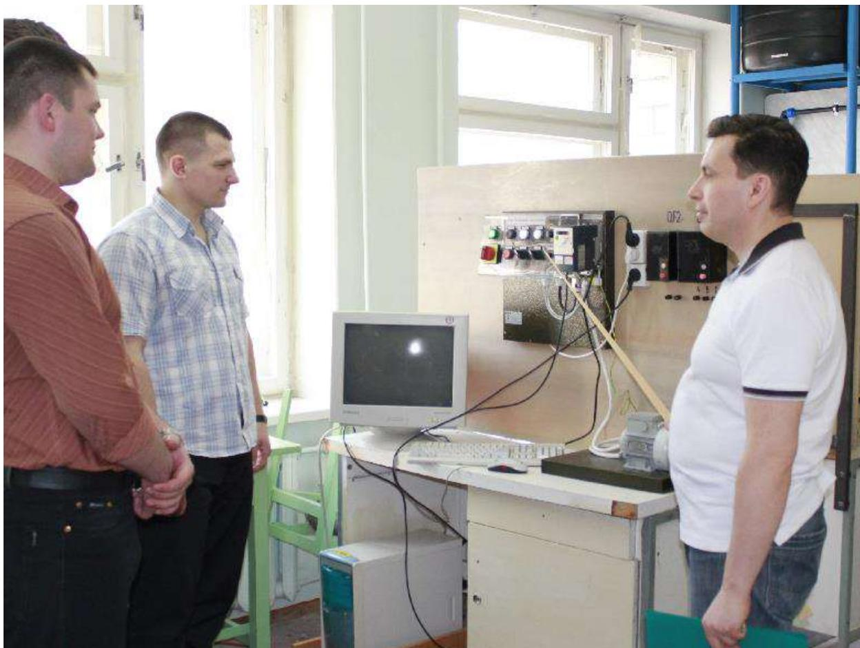
**Лабораторный стенд «Преобразователь частоты Altivar»**
