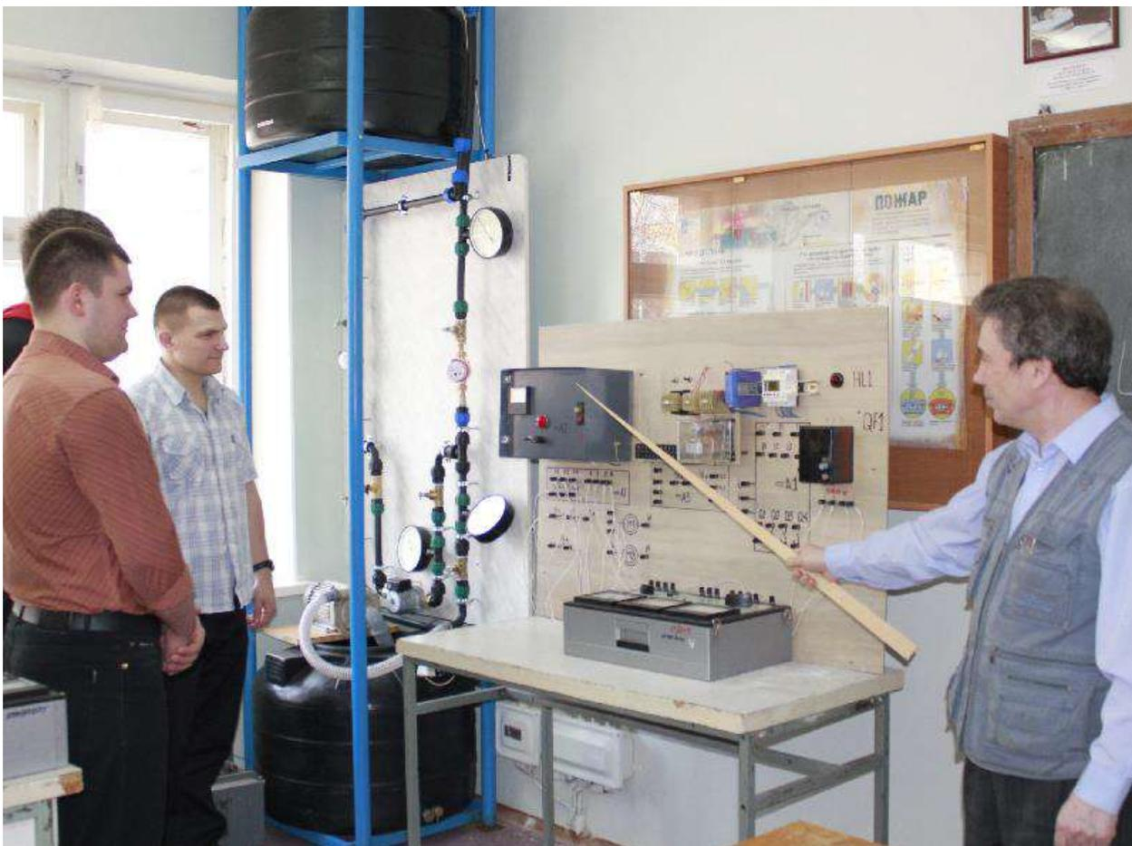
**Лабораторный стенд «Электропривод водоснабжающей установки с ПЛК «Schneider electric»**
